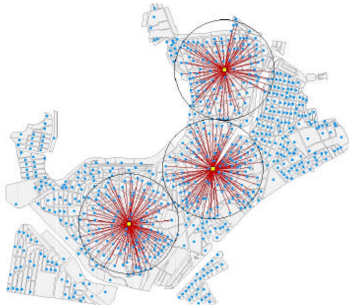
Figura 2: Solução de máxima cobertura para 3 antenas
