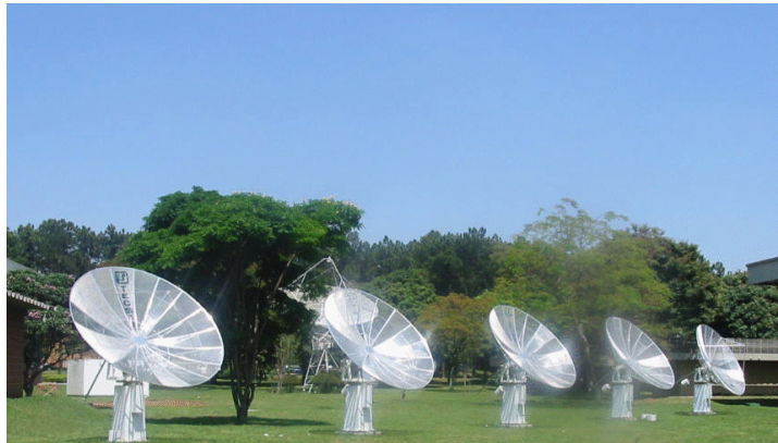
Figura 15 – O arranjo inicial de antenas do BDA-INPE para observação de explosões solares em radiofrequência com alta resolução temporal e espacial.
